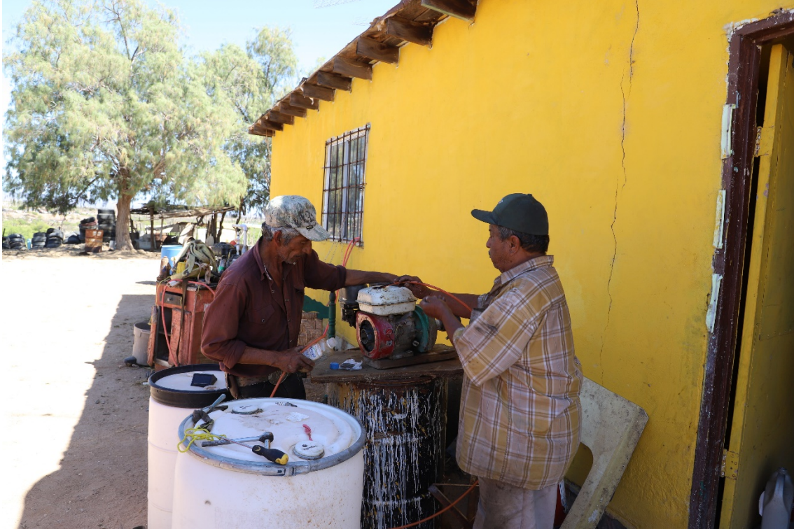
Figura 8. Señores Sixto Medina (izquierda) y David Torres (derecha) reparando la motobomba que se usa para reabastecer la Tinaja de la Rinconada.
